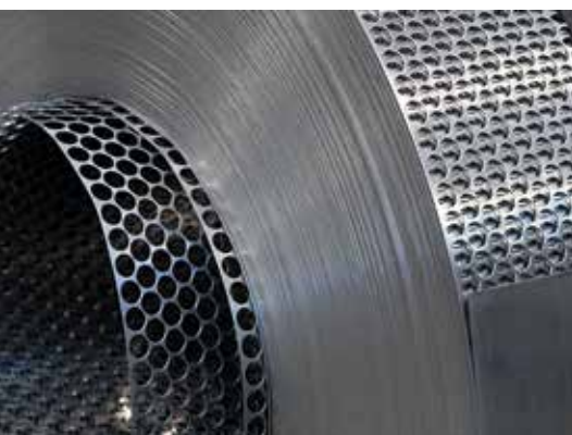
— Bobine de métal une fois les flans découpés Metal coils after the cutting of blanks flans
