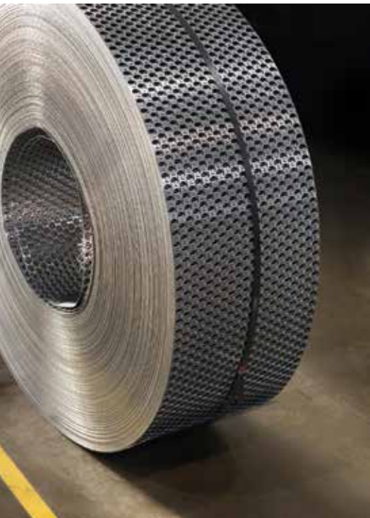
— Bobine de métal une fois les fleurs découpés Metal coil after the cutting of blanks
