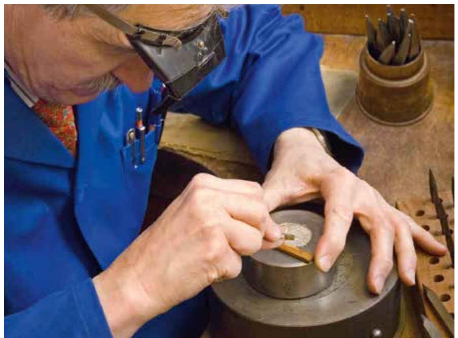
Travail sur un outillage - Atelier de gravure -Paris Work on a master die - Engraving workshop, Paris
