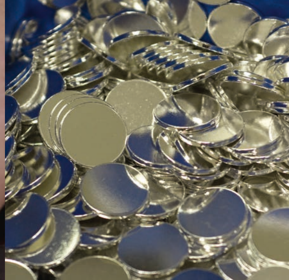
Flans après découpe Blanks after cutting
